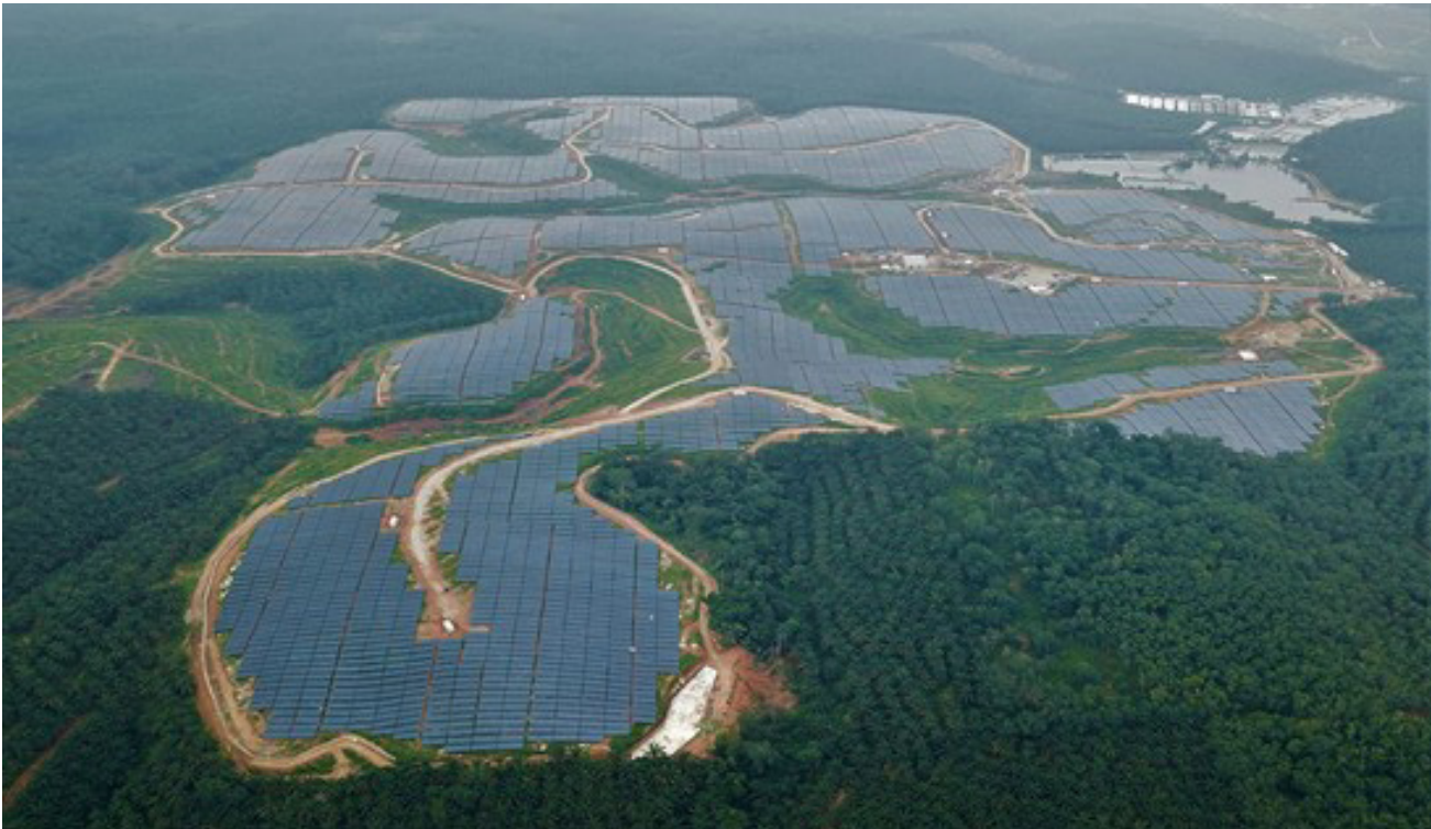
Foto 3: Contoh pembangunan ladang solar di Sungai Siput, Perak dengan kapasiti 60MW
