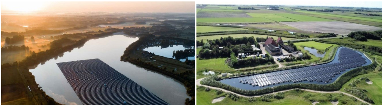
Foto 18: Elemen landscape screening yang diterapkan di ladang solar atas permukaan air
