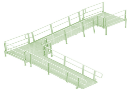
Rajah 17 : Ilustrasi bagi penyediaan pelantar rata ( Landing )
