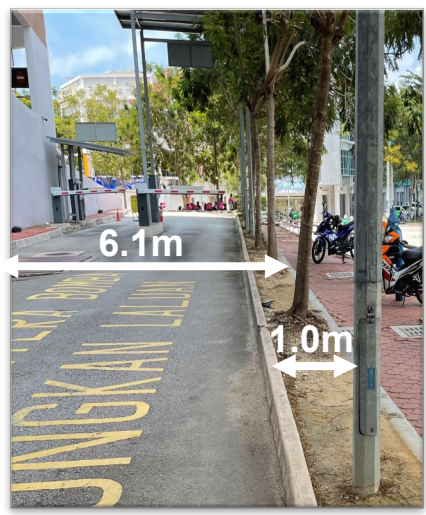
Foto 4 : Contoh penyediaan perimeter planting tepi minimum 1 meter yang diambil kira sebahagian di dalam anjakan tepi bangunan 6.1 meter
