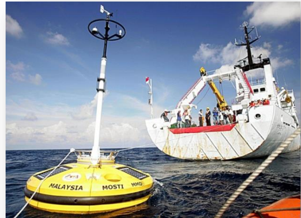
Foto 9.2: Sistem Amaran Awal Tsunami Nasional Malaysia (SAATNM) yang disediakan oleh MOSTI
