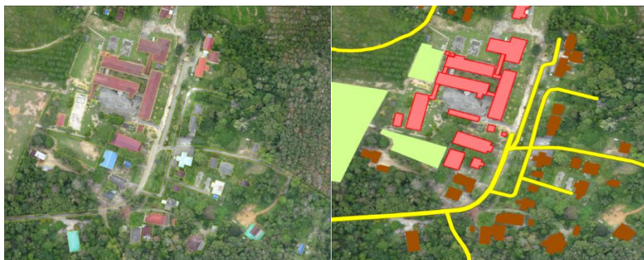
Rajah 9.4: Pendigitan Garisan Bangunan Menggunakan Orthophoto
